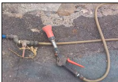
Tratamiento con pistola y manguera. Centro abajo y derecha, dos modelos de pistola de tratamiento. Centro arriba: un detalle de la boquilla.
