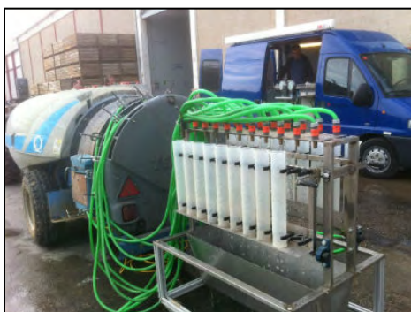
Estación ITAEF móvil revisando un pulverizador hidroneumático
