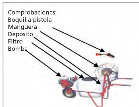
Puntos a revisar de una carretilla de tratamiento
