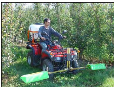
Izquierda: Aplicación con campanas de tratamiento. Derecha. Campanas de tratamiento para lanzas para boquillas de hendidura (arriba) y para boquillas de turbulencia (derecha).
