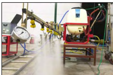
Revisión de la presión de trabajo al final de una barra portaboquillas de un pulverizador
