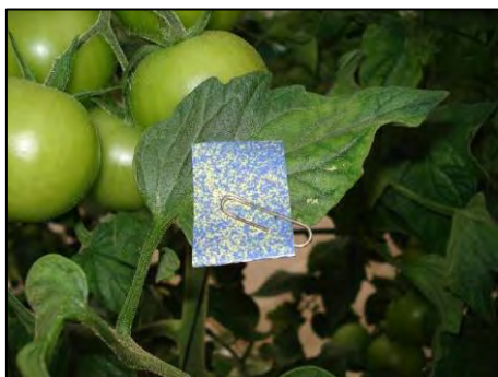
Papel hidrosensible en el haz de la hoja tras un tratamiento. El color azul indica el producto que llega
