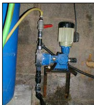
Equipos de inyección para aplicación de fitosanitarios en el riego localizado (Venturi a la izquierda, bomba de membrana a la derecha)
