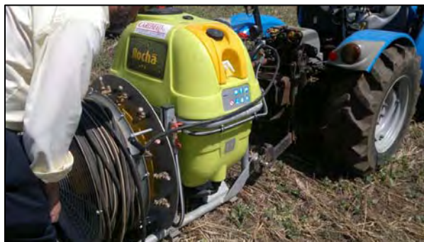
Pulverizador hidroneumático con depósito de 200 litros. Puede aplicar el producto en pulverización hidráulica y en atomización (se ve el ventilador).
