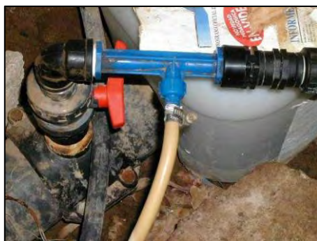
Equipos de inyección para aplicación de fitosanitarios en el riego localizado (Venturi a la izquierda, bomba de membrana a la derecha)
