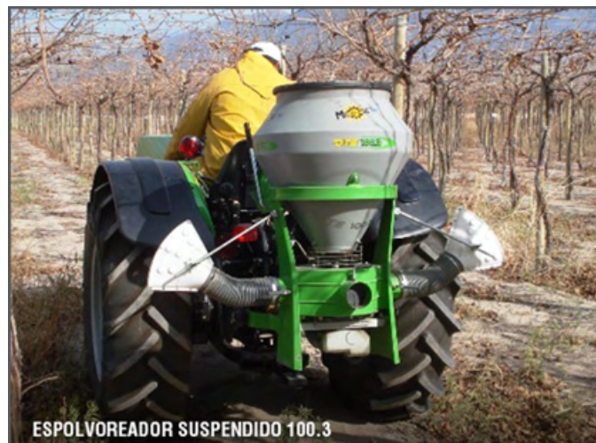
Espolvoreador suspendido a tractor con dos deflectores
