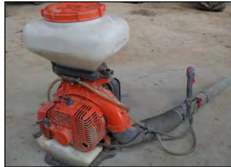
Atomizador con posibilidad de cambio a espolvoreador (parte negra bajo el depósito)
